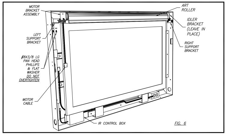
DISCONNECT MOTOR CABLE FROM THE IR CONTROL BOX AS SHOWN IN FIG 6.
